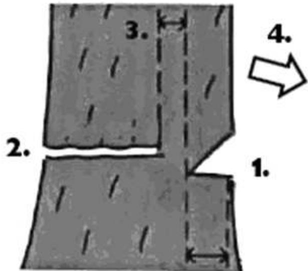
Bild oben: Fallkerb ca. 1/5 des Baumdurchmessers bei 45°
